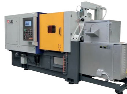
Inyectora de Pistón de Zamak 80 Tn
