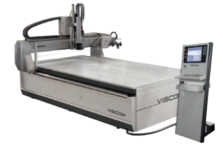
2 Fresadoras de Pórtico máximo 1.300x700 mm
