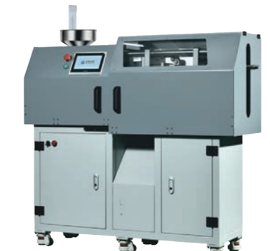
Inyección de Plástico ABS cromable y Flexible 12 Tn
